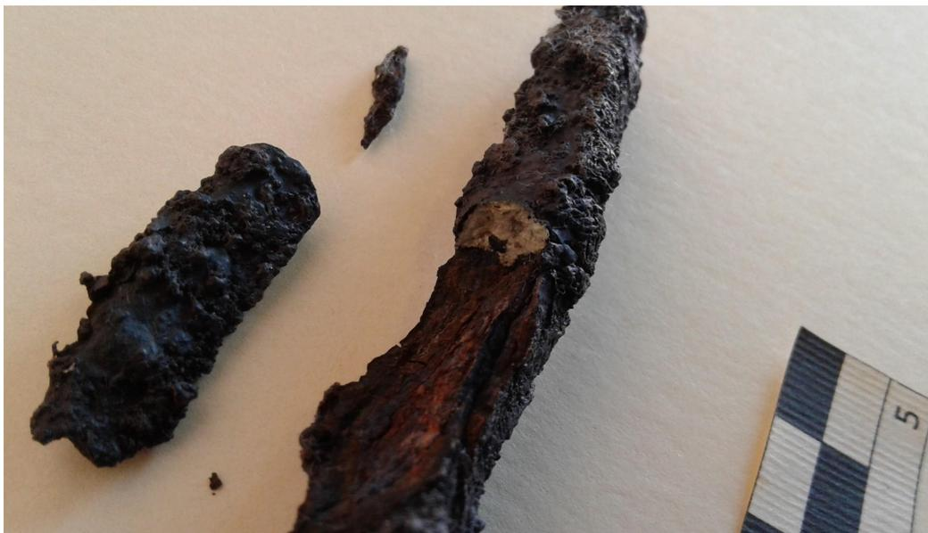
Imagen 4. Detalle de los subproductos de corrosión y sus distintos colores.
