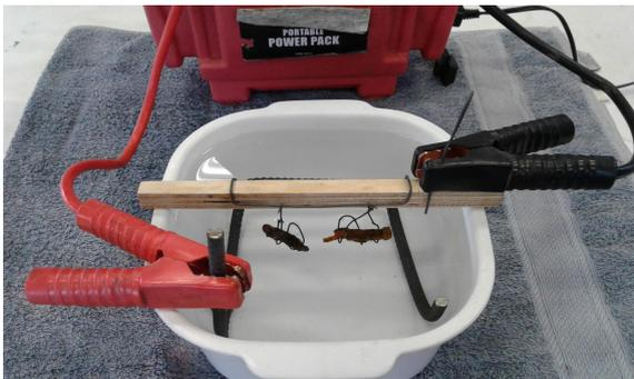
Imagen 5. Celda de electrólisis.
