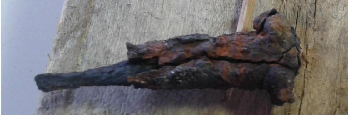
Imagen 9. Vetas y vacíos en la estructura del clavo.
