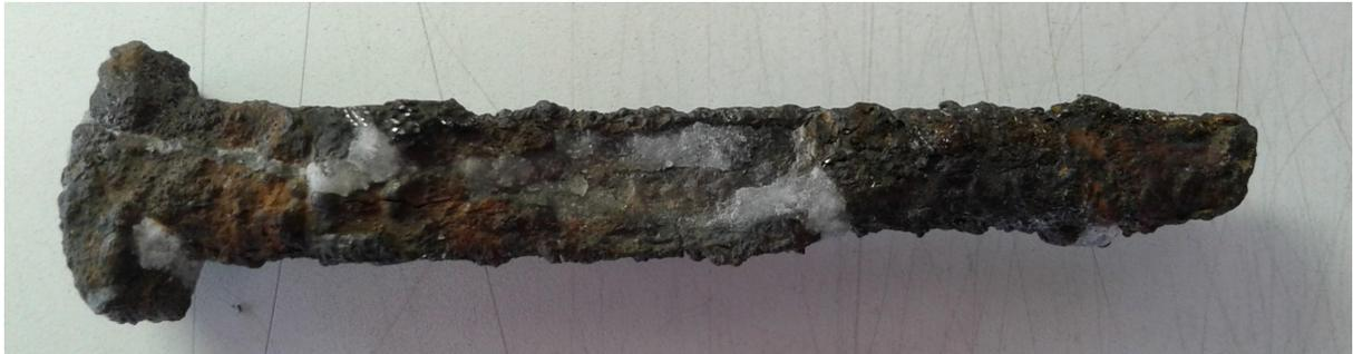
Imagen 13. Objeto resanado con mezcla de bicarbonato de sodio y cianocrilato.
